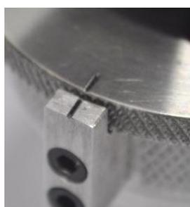
6.2.5\_ Segurar o corpo do durômetro com uma das mãos e apoiar-lo sobre a superfície do macho/molde de maneira que o durômetro fique perpendicular ao plano da superfície do macho/molde;
