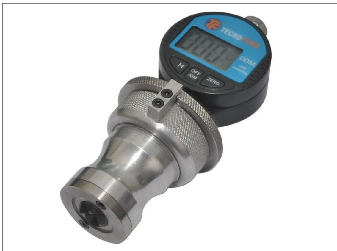
Figura 1 – Durômetro para areias aglomeradas quimicamente.
